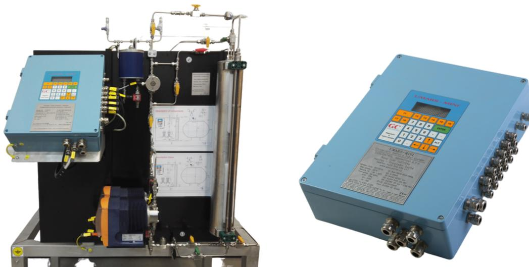
Výhody DAMEODU jsou takové, že provozovatelé nemusí kontrolovat na koncových větvích koncentraci odorantu ručními přístroji, ale mohou tyto hodnoty pohodlně sledovat z dispečinku. Tím mohou dálkově nastavovat požadované mg/Nm<sup>3</sup> na odorizačních stanicích, což vede ke značné úspoře. Lze také provádět tisk ve formě protokolu či v tabulkovém formátu, kdy bude možno zpětně doložit množství koncentrace v daném dni a čase.
