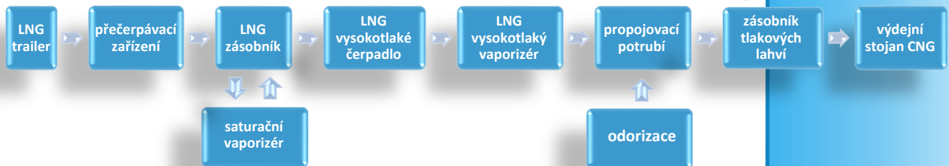
obr. TYPICKÉ BLOKOVÉ SCHÉMA L-CNG STANICE
